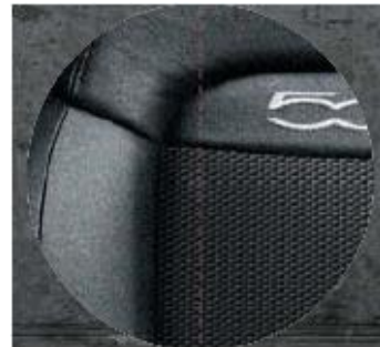
Комбінована оббивка сидінь структурованою сірою тканиною з тривимірною вишивкою і вставками з еко-шкіри чорного кольору (030/032)
